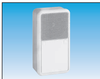
KEL 2/1-T Haut-parleur mural saillie (AP) ou semi encastré (UP) 100 V - 6 W - BP : 250 - 20000 Hz Pression acoustique 1 W / 1 m : 86 dB Encombrement : L 81 x H 152 x P 46 En semi encastré découpe : L 72 x H 139 x P 11/35 • 0,5 kg Boîtier plastique - grille métal : blanc RAL 9016.
