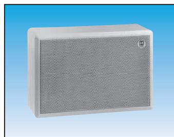
ZL 135 G-T6 Haut-parleur mural saillie 100 V - 6 W - BP : 100 - 20000 Hz Pression acoustique 1 W / 1 m : 91 dB Encombrement : L 260 x H 175 x P 81 • 1,3 kg Boîtier plastique - grille métal : blanc.
