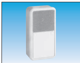
40.006.32 Haut-parleur mural KEL 2/1-20 saillie (AP) ou semi encastré (UP) 20 Ohms - 6 W - BP : 250 - 20000 Hz Pression acoustique 1 W / 1 m : 86 dB Encombrement : L 81 x H 152 x P 46 En semi encastré découpe : L 72 x H 139 x P 11/35 • 0,4 kg Boîtier plastique - grille métal : blanc RAL 9016.
